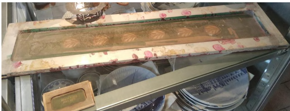
Fig. 16. Ecran pour la sérigraphie (© Collection Keramis)
