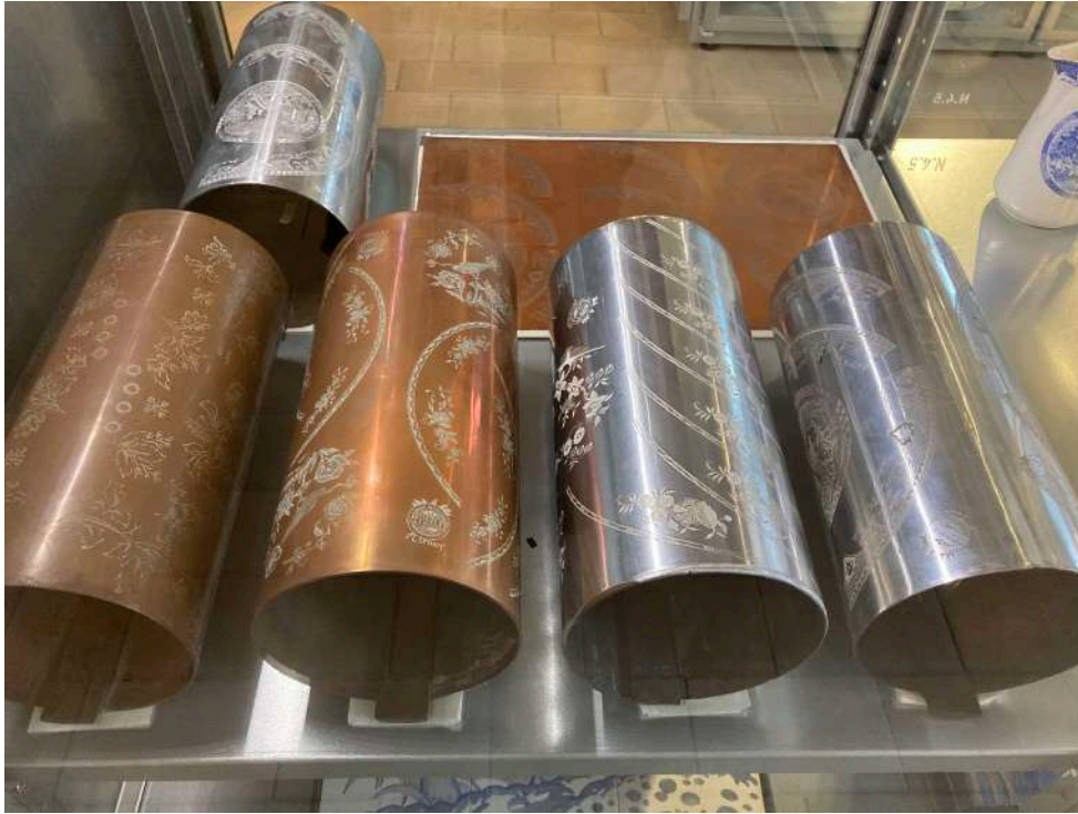
Fig. 6. Cylindres réalisés par galvanoplastie (© Collection Keramis. Don des enfants de Jean-Pierre Cavenaile)
