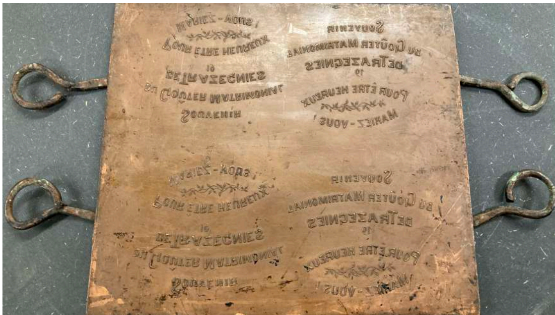
Fig. 14. Matrice galvanoplastique de la planche du Goûter Matrimonial de Trazegnies (© Collection de la Fédération Wallonie-Bruxelles, en dépôt à Keramis)
