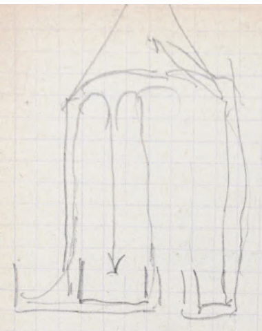
Schema dat de circulatie van vlammen in een flessenoven toont, ontleend aan een notitieboekje uit 1902
